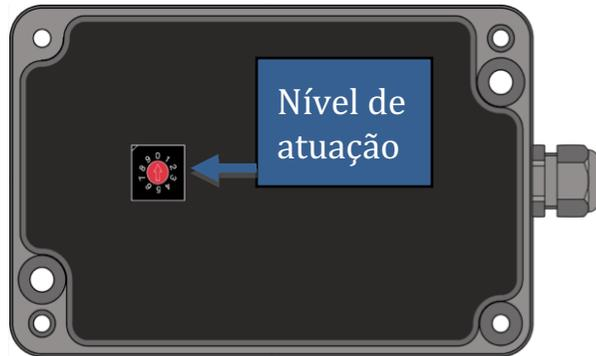
O **MVB06V-ITR-24VDC** é dotado de um relé interno de estado sólido que pode ser usado para alarme e/ou para desligamento do equipamento a ser monitorado quando a vibração alcançar o nível de atuação ajustado.
